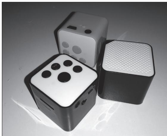
*Fig. 10* Tre esemplari del piccolo apparecchio riproduttore che abbiamo scelto per i ragazzi ciechi del Togo: un cubo di circa 3 cm di lato con tasti ben riconoscibili al tatto, altoparlante, presa per la cuffia e batteria interna che si carica come un cellulare.
